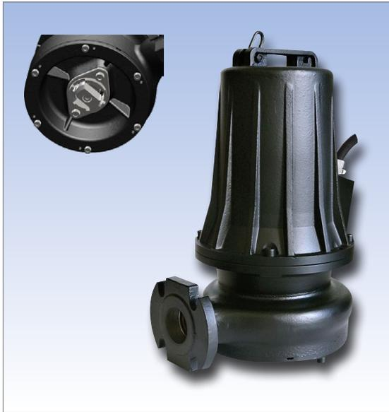
Les pompes de la gamme G disposent d'un système déchiqueteur de substances solides en entrée. Elles sont fréquemment utilisées lorsqu'on doit faire passer des fluides contenant des matières solides par des conduites existantes, de diamètre relativement faible. Domaines d'utilisation: égouts domestiques, liquides avec des substances solides et chaque fois qu'une grande hauteur de relevage est exigée.
