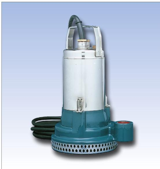
Ce sont des pompes submersibles avec rotor ouvert et revêtement en caoutchouc résistant à l'usure pour les eaux propres et usées. Avec ou sans interrupteur à flotteur à câble ou à tube. Assèchement de fossés et de zones humides. Vidage de réservoirs de collecte d'eau de pluie et d'infiltration. Dispositifs d'irrigation avec soutirage d'eau dans un bassin collecteur, des fossés, de petits lacs et des cours de ruisseau. Vidage de caves, garages et espaces inondés.
